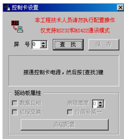
在查找到控制卡后，可以根据使用的显示板的配置驱动板的属性。对于 II 型和 IV 卡，在进入高级设置时，将出现如下画面：
