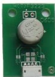
**亮度传感器：**CL2005 系列控制卡也可以在 JIN2 位置接入亮度传感器采样环境光亮度，实现亮度的自动调节。亮度传感器外型如下图所示：
