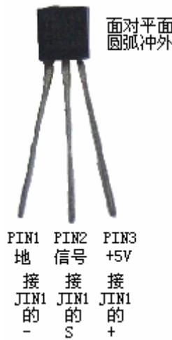
**湿度传感器:** CL2005 系列控制卡可在 JIN2 位置接入湿度传感器采样环境湿度，并将湿度数据通过时钟版面设计在显示屏上显示。DS18B20 的引脚定义如下图：
