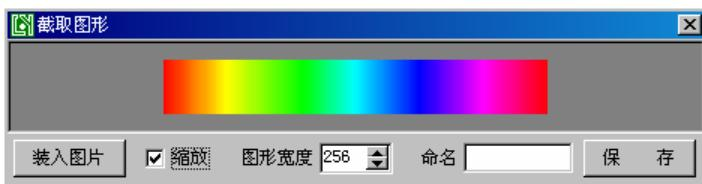
在这个界面中,先装入图片,然后设定图形的宽度,软件将以给定的宽度为周期循环取图片数据铺满 2048 点。在这里可以给图形取一个名字,以便区分。然后保存图形。
